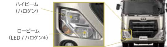
ハイビーム走行中、カメラとミリ波レーダーが対向車・先行車を検知した場合、自動的にロービームに切り替えます。ハイビーム走行をしやすくすることで安全性を高めます。
