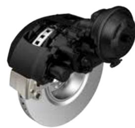
放熱性と耐フェード性に優れたディスクブレーキは、積載時に長い下り坂を走行する際でも、確かな制動性能を発揮します。また、水の侵入の影響を受けにくいため、悪条件下でも安定した制動力を発揮します。ブレーキペダルの動きに素早く滑らかに応答し、制動時のショックも少ないので、大切な積荷の荷崩れ防止にも効果的です。
