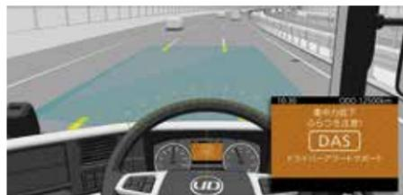
キャブ内に装備したカメラが走行車線と車両との位置関係を認識し車両のふらつき状況から運転に対する集中度を推測します。集中度が低下したと判断した場合に、2段階の警告音とマルチディスプレイのウォーニングメッセージの表示でドライバーに注意喚起し、休憩を促します。
