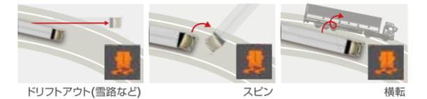
全車種に採用しているUDSCは、カーブや滑りやすい路面などで車両の不安定な状態をセンサーが検出すると、エンジン出力やブレーキ各タイヤへの制動力を適切に制御し、車両の姿勢を安定させます。
