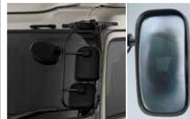
鏡面電動ミラー&4点式ミラーヒーター
