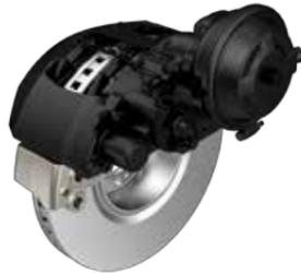
放熱性と耐フェード性に優れたディスクブレーキは、積載時に長い下り坂を走行する際でも、確かな制動性能を発揮します。また、水の侵入の影響を受けにくいため、悪条件下でも安定した制動力を発揮します。ブレーキペダルの動きに素早く滑らかに応答し、制動時のショックも少ないので、大切な積荷の荷崩れ防止にも効果的です。
