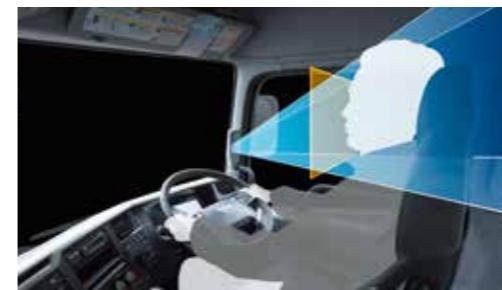
ピラーに搭載されたカメラでドライバーの脇見/運転姿勢/閉眼の状態をモニターし、前方への注意不足を検知すると警告音とウォーニングメッセージで注意を促します。居眠り運転等の事故抑制に貢献します。
