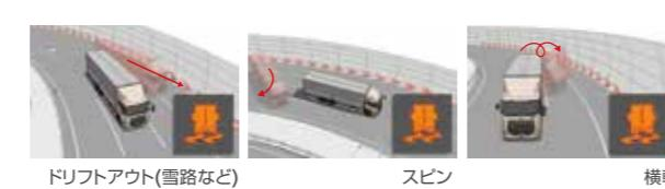
全車種に採用しているUDSCは、カーブや滑りやすい路面などで車両の不安定な状態をセンサーが検出すると、エンジン出力やブレーキ各タイヤへの制動力を適切に制御し、車両の姿勢を安定させます。
