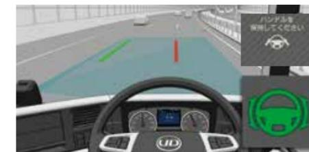
1 キャブ内カメラが左右の走行車線を検知し、車速50km/h以上で走行中にドライバーが意図せず走行車線から逸脱するとシステムが操舵介入しステアリング操作を支援します。
