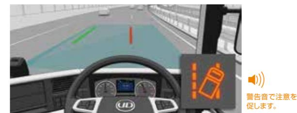
キャブ内に装備したカメラが左右の走行車線を検知し、車速50km/h以上で走行中にドライバーが意図せず走行車線から逸脱すると警告灯と警告音で注意を促します。
