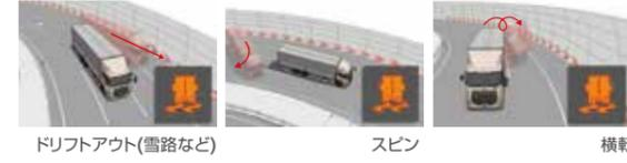
全車種に採用しているUDSCは、カーブや滑りやすい路面などで車両の不安定な状態をセンサーが検出すると、エンジン出力やブレーキ各タイヤへの制動力を適切に制御し、車両の姿勢を安定させます。
