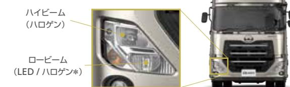
ハイビーム走行中、対向車を検知し自動的にロービームへ切り替え。ハイビーム走行中、カメラとミリ波レーダーが対向車・先行車を検知した場合、自動的にロービームに切り替えます。ハイビーム走行をしやすくすることで安全性を高めます。
