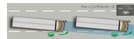
2 180秒以内に2回以上の連続介入とドライバーのステアリング操作が確認できない場合ウォーニングメッセージと警告音による警報が作動します。
