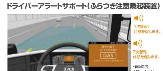
キャブ内に装備したカメラが走行車線と車両との位置関係を認識し車両のふらつき状況から運転に対する集中度を推測します。集中度が低下したと判断した場合に、2段階の警告音とマルチディスプレイのウォーニングメッセージの表示でドライバーに注意喚起し、休息を促します。
