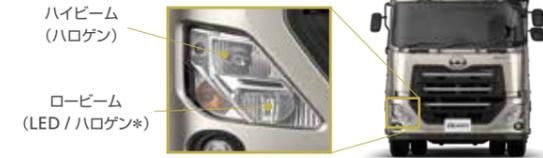
ハイビーム走行中、対向車を検知し自動的にロービームへ切り替え。ハイビーム走行中、カメラとミリ波レーダーが対向車・先行車を検知した場合、自動的にロービームに切り替えます。ハイビーム走行をしやすくすることで安全性を高めます。
