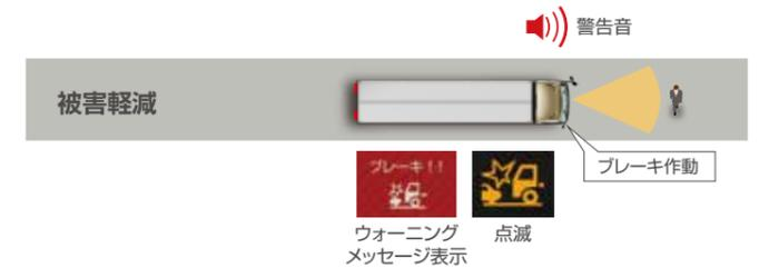
追突・衝突の可能性がある距離まで接近すると、警告灯、ウォーニングメッセージ、警告音と同時に、速やかにブレーキが作動し被害を軽減します。
