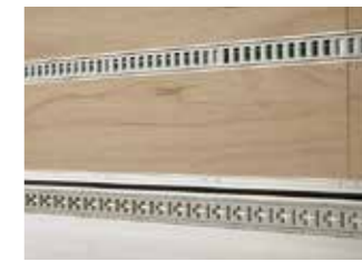
ラッシングレール2段
