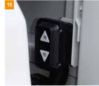
ウイング開閉スイッチ 前壁部
