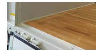
フロント内板厚変更
