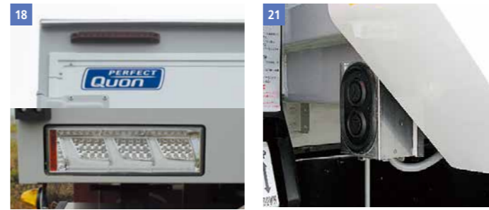
18 小糸製LED テールランプ/リヤトップマーカ 21 ウィング開閉スイッチ 前壁部
