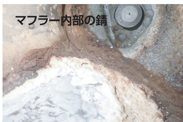
Quon 2017年モデルマフラー内に錆及び変色が発生した状態
