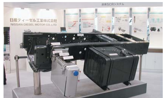
■ 尿素SCRシステム展示モデル (車両左側)
