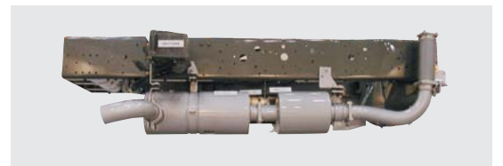
■ 尿素SCRシステム展示モデル (車両左側)
