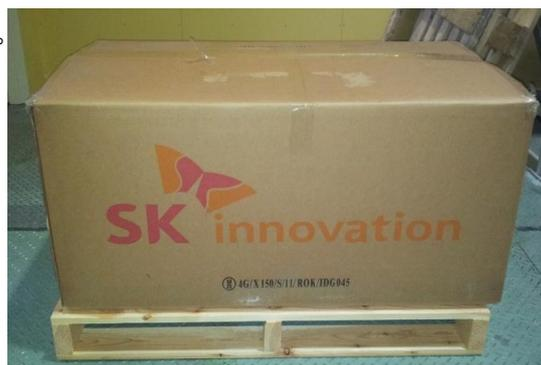
7. 送付されたときに結束されていたPPバンドを再利用して、専用段ボール箱と専用パレットを結束して固定します。
